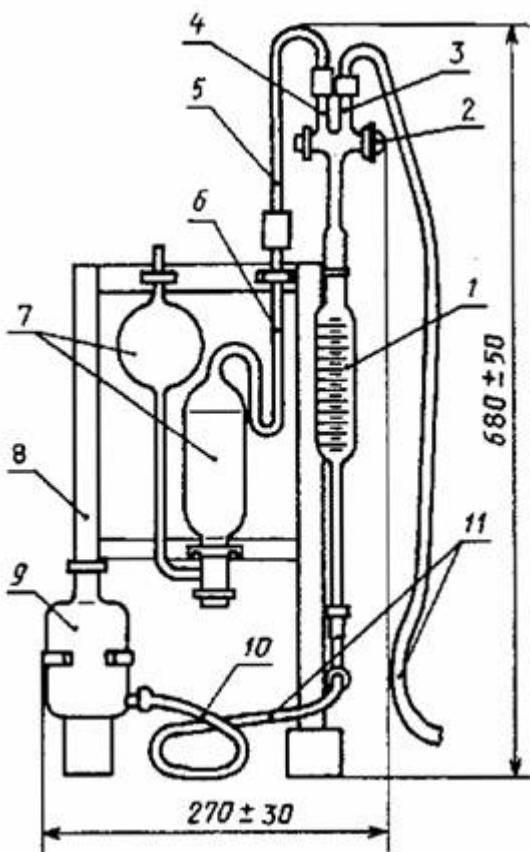
1 - бюретка; 2 - двухходовой кран; 3,4 - отростки крана; 5,6 - капиллярные стеклянные трубы; 7 - поглотительная пипетка с капиллярной трубкой; 8 - штатив; 9 - уравнительная склянка; 10, 11 - резиновые трубы
