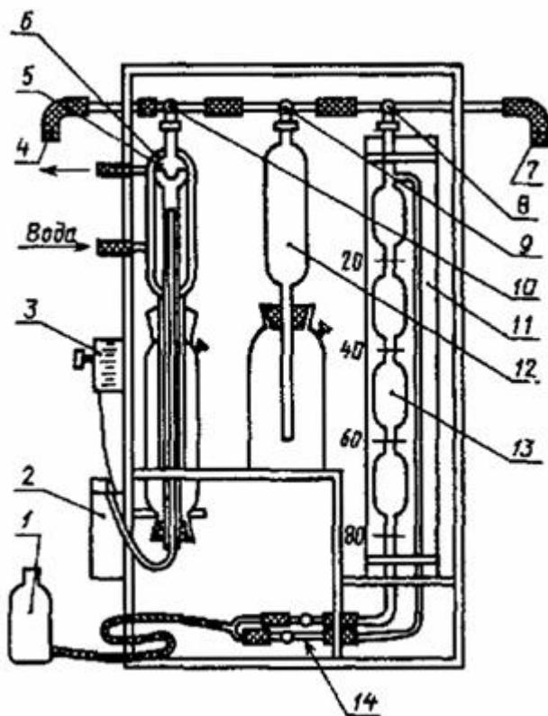
1 - уравнительная склянка; 2 - трансформатор на 60 Вт (первичная обмотка на 220 В, вторичная на 2-3 В); 3 - реостат на 3-5 Ом, 5-6 А; 4, 7 - резиновые трубы; 5 - спираль из платиновой проволоки диаметром 0,3 мм, длиной 60 мм; 6 - сжигательная пипетка с водяным охлаждением; 8, 9, 10 - краны распределительной гребенки; 11 - водяная рубашка; 12 - поглотительный сосуд; 13 - измерительная buretka; 14 - переходник
